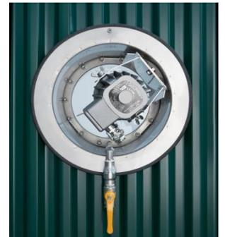
Защитная розетка для иллюминаторов RD 300/RD 400 из нержавеющей стали 304 для аккуратного соединения с кожухом чана. Длина 20 см, буртик 5 см. Крепление и возможная торцовка осуществляются заказчиком.
