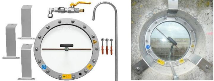
Hublot RD 400, avec essuie-glace diamètre du cercle de mouvement 330 mm avec buse de lavage en acier inoxydable, verre spécial diamètre 350 mm / 15 mm, avec joint annulaire en caoutchouc/acier inoxydable 316 pour le montage direct résistant à la pression dans un trou ou une douille de diamètre 400 mm, avec cornière de fixation en acier inoxydable, article n° : 80104001
