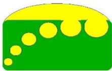
Douille-mandrin DN 300 & DN 400, rainuré, pour le montage direct du hublot, avec disques en polystyrène dure pour assurer la rigidité, largeur 20, 25 et 30 cm, autres largeurs possibles
