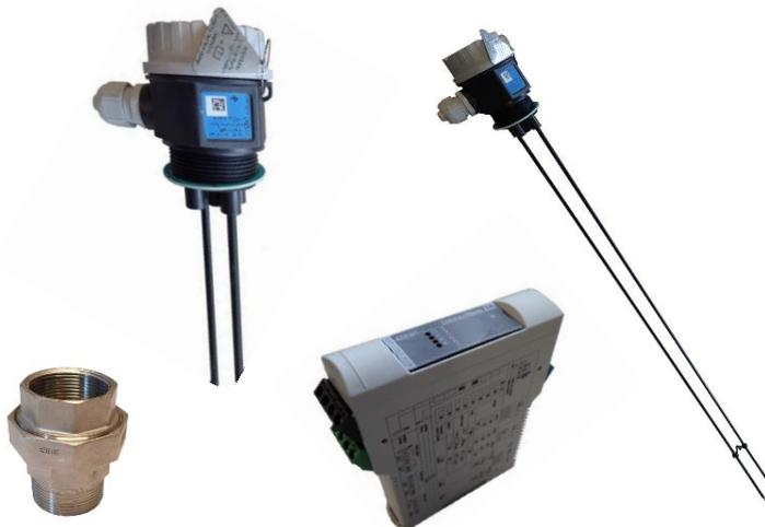
Relais de sonde E+H, Nivotester FTW325 conducteur; certificats ATEX, WHG, Boite: montage sur profilé chapeau 22,5 mm , Alimentation: 85...253 Volt, Sortie: contact inverseur 1x niveau et 1x alarme
