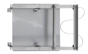
Disco di sovrapressione in lamiera di acciaio inox 48 x 48 cm con vetrino d'ispezione integrato con raschino; incl. telaio a pressione, guarnizione con scanalatura laterale e limitatore di corsa
