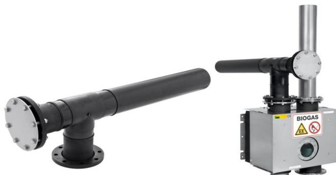
Соединительный переходник для TT повышенного/пониженного давления 150/200 из нерж. стали 316, в комплекте со стальной (316) заглушкой, прокладкой и болтами. Фланец DIN из нерж. стали 316 DN 150 / DN 200 для прямого соединения с устройством защиты, полностью из нерж. стали.
