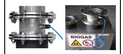
Calefacción adicional para ÜU-TT 150 / 200 / 273 / 300, CETAL, TPAE, Ex d II C T1 Ex II 2GD con termostato y limitador de temp., control según DIN-VDE 0100 y normas de fabricante, tensión nominal 230 V, 50Hz
