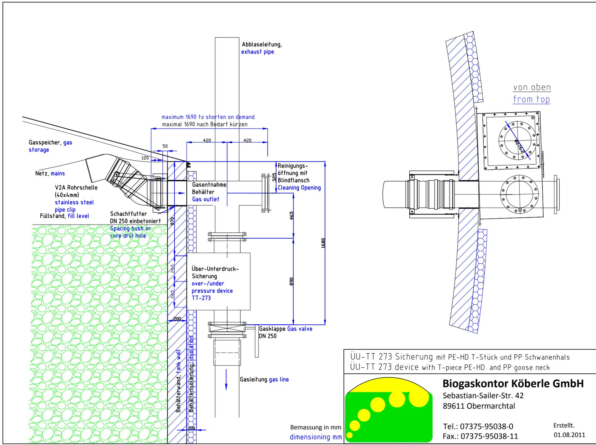
ÜÜ-TT 273 Sicherung mit PE-HD T-Stück und PP Schwanenhals
